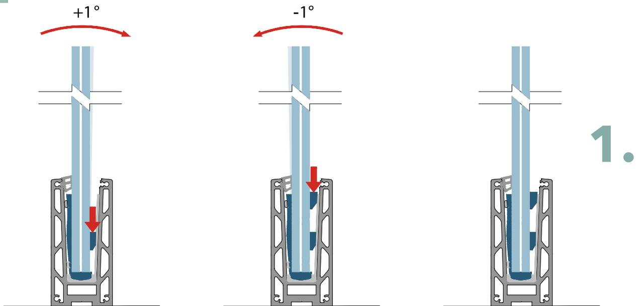
GLASSMOVE est le système de réglage et d'alignement des panneaux verre exclusif de KOZZA France. Il est conçu et plébiscité par les installateurs pour sa simplicité de mise en oeuvre et son efficacité pour réaliser un alignement parfait de vos volumes de verre.
