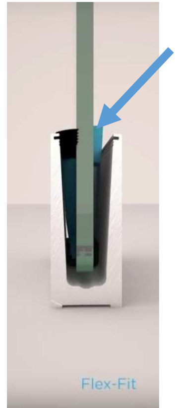
3-Pose des cales de blocage sans verrouiller la cale au fond du profilé ... (voir ill. 6)
